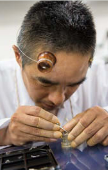
部品の反りや狂い一つひとつ調整しながら組み立て。マイクロン単位の精度が要求されます。
