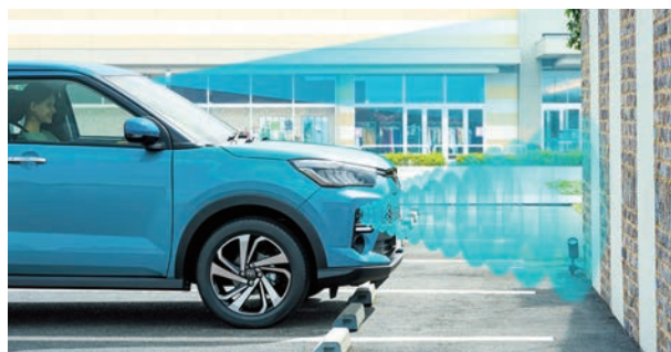
前方や後方の障害物を検知、踏み間違いによる誤発進を抑制します
